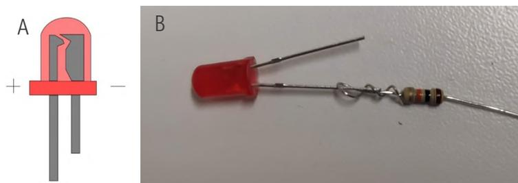
Figura 49. Pinos positivos e negativos do LED (A) e LED com a resistência soldada e isolada (B).
