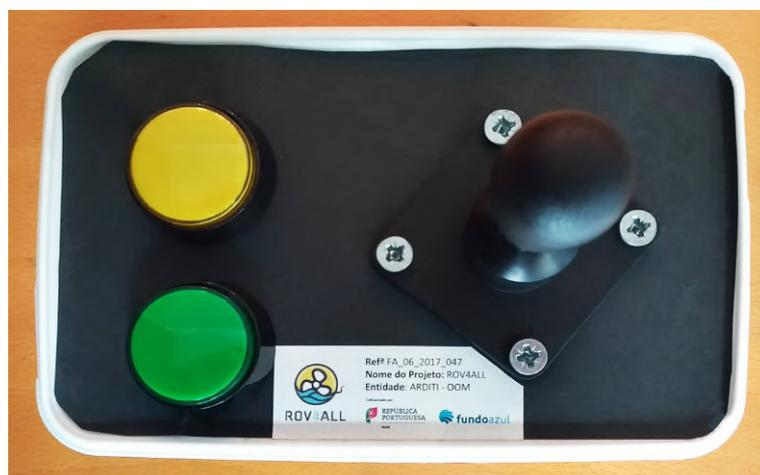
Figura 14. Consola ROV4ALL onde são visíveis o joystick, à direita (em posição romboidal), e à esquerda os botões de subida e de descida.
