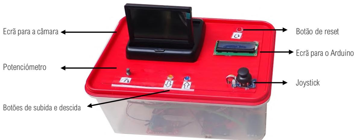
Figura 40. Exemplo de consola construída para o kit ROV4ALL - versão avançada, onde é visível o joystick, os botões de subir e descer, de reiniciar o sistema, o potenciómetro, o mostrador do sensor de temperatura e o monitor da câmara de filmar.
