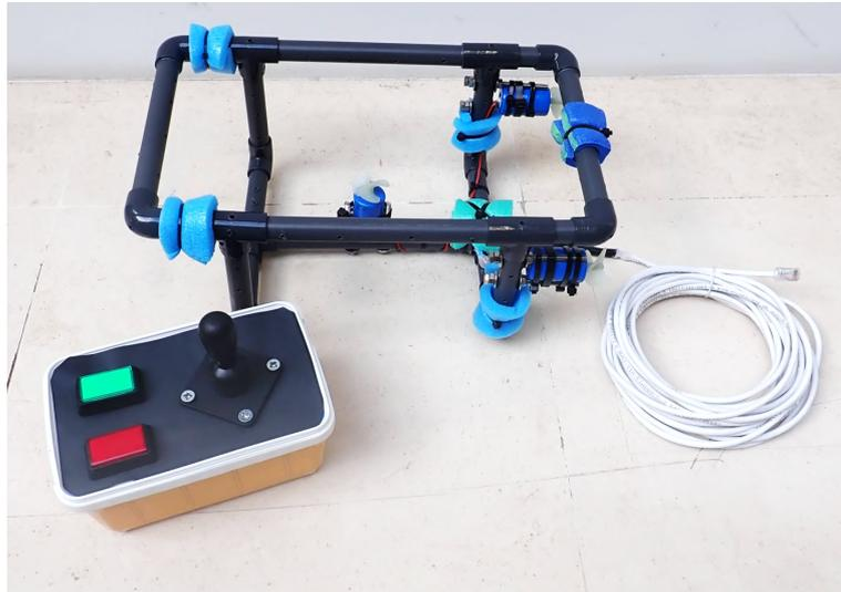
Figura 12. ROV construído com o kit ROV4ALL - versão básica.
