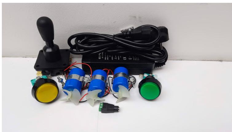
Figura 13. Componentes que integram o kit ROV4ALL - versão básica.
