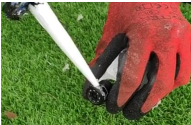
Figura 46. Isolamento da câmara de filmar na caixa estanque.
