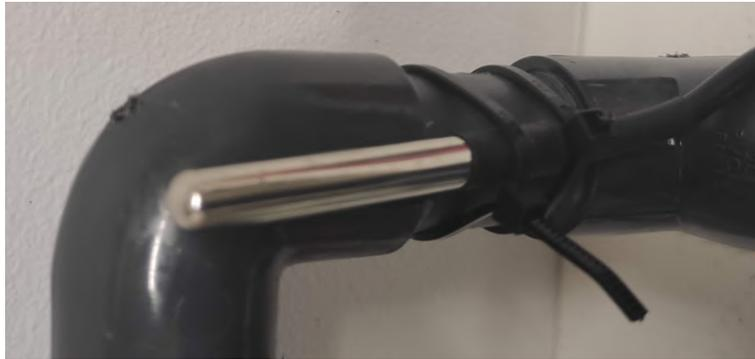
Figura 48. Sensor de temperatura, já instalado no chassi.
