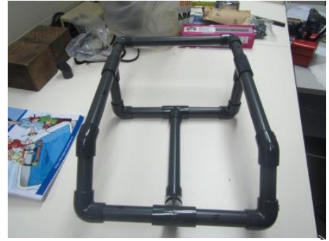
Figura 5 – Estrutura do ROV construída em PVC.
