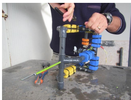
Figura 50. Fixação de material flutuante, neste caso, esponja, no chassi.
