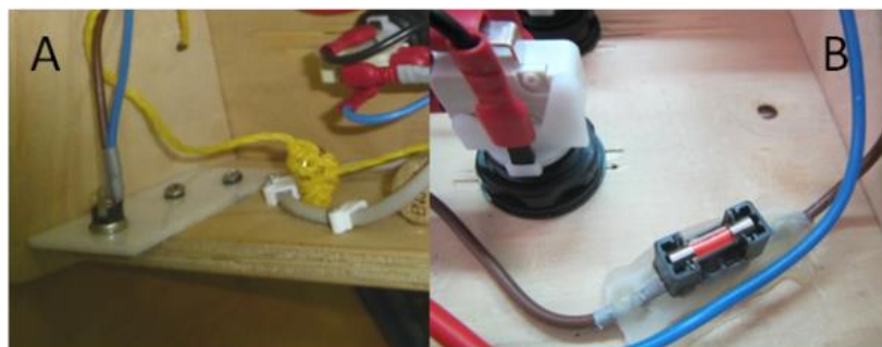
Figura 32. Fixação do jack-fêmea e do porta-fusível à consola.
