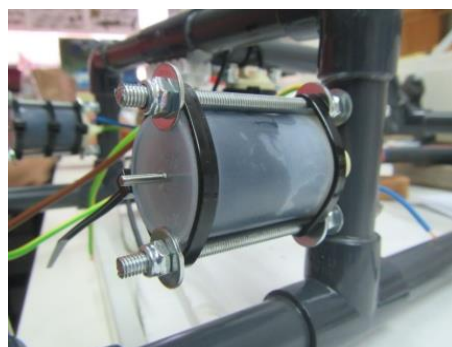
Figura 39. Fixação dos motores no chassi do veículo.
