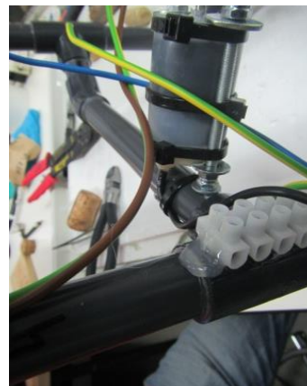
Figura 45. Barra de junção colada no chassi.
