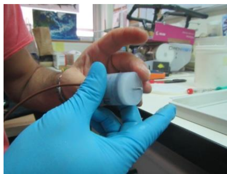
Figura 36. Inserção do motor no frasco de plástico.
