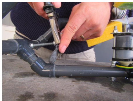
Figura 49. Colocação de chumbo na zona traseira do ROV para contrabalançar o peso frontal dos motores.
