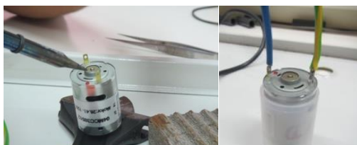
Figura 33. Soldadura dos fios aos terminais do motor.
