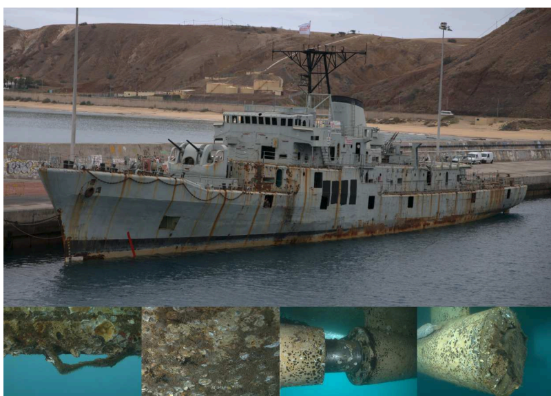
Figura 10: A CORDECA antes do seu afundamento. Em baixo: detalhes do casco aquando da inspecção subaquática.
