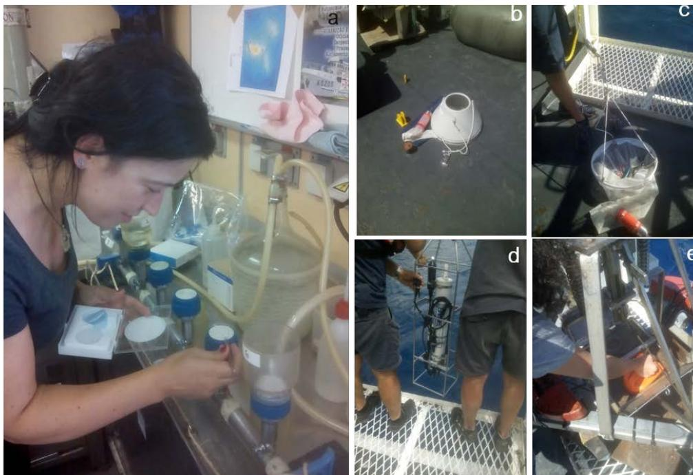
Figura 7 - a) Sistema de filtração de água para análise de pigmentos por HPLC e de nanoplâncton; b) rede Apstein para colheita de fitoplâncton; c) rede Apstein para colheita de microzooplâncton; d) sistema CTD; e) colheita de sedimento com a draga SMT..
