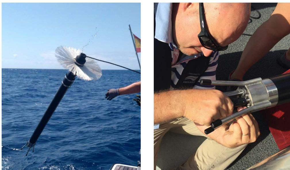
Figura 33 - VPM durante a sua utilização. A franja a branco visível na imagem da esquerda serve para estabilizar o equipamento durante a descida na água.
