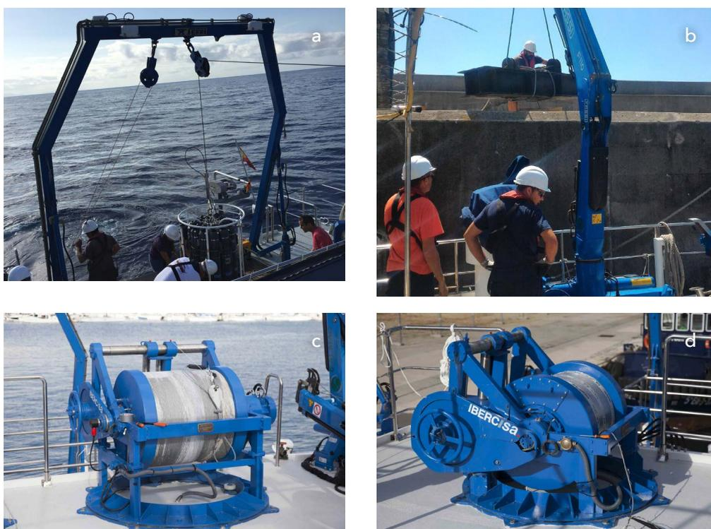
Figura 28 - Equipamento para elevação e movimentação dos instrumentos oceanográficos; a) porta hidráulica; b) grua; c) guincho hidráulico; d) guincho portuário.
